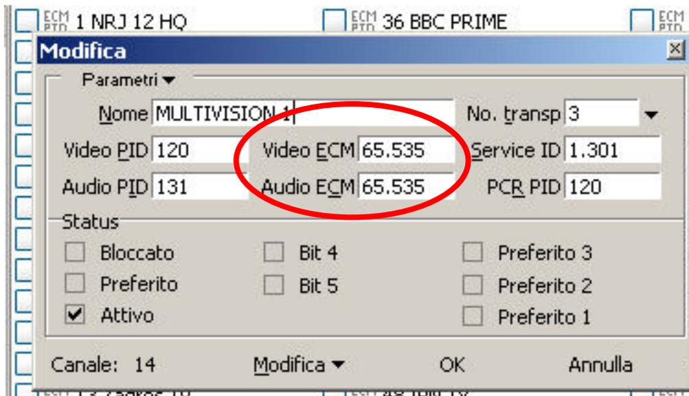
Nella finestra di modifica del canale, oltre ai vari parametri ci sono i due parametri Video ECM e Audio ECM, che normalmente sono settati a FFFF (65535 in dec). Questi due parametri si fanno carico di interpretare (detto in parole povere) cosa decodificare e con quale codifica, nel caso del Video ECM l'immagine video mentre per l' Audio ECM il sonoro.
