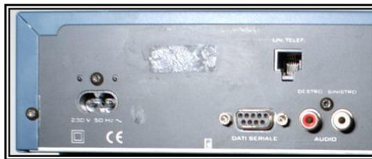
Questa è la parte posteriore del decoder e dalla posizione della presa telefonica si ha a che fare con un **DSX 6070 - DST 175 – DST 185**.
