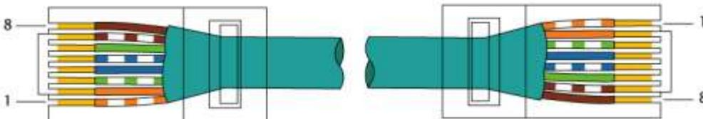
Per caricare il firmware via seriale sul dreambox serve un cavo seriale nullmodem:
